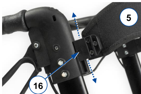
Figura 3: Montaggio/smontaggio a scorrimento della fascia dello schienale
