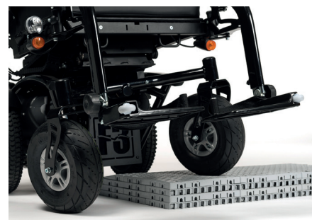
Barra anteriore snodata, che permette di mantenere tutte le ruote appoggiate al suolo
