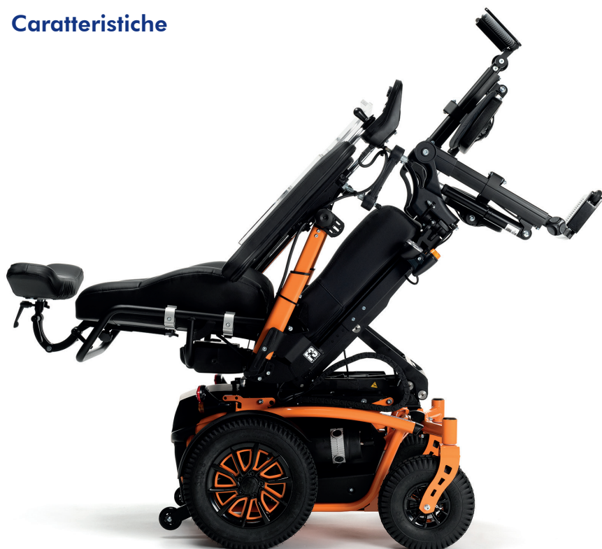
Regolazione elettrica dell'inclinazione dello schienale e del basculamento del sedile
